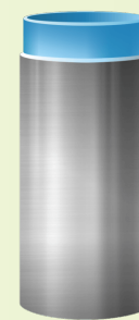
Стальная труба \varnothing 133\text{мм} ПНД \varnothing 117\text{мм}
