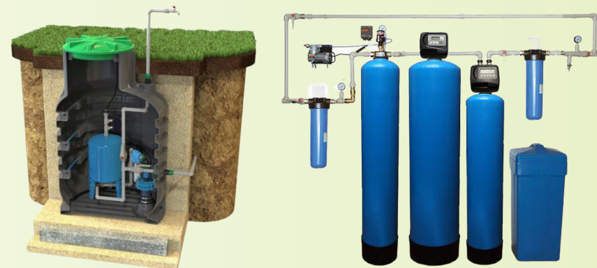
Устройство дачного водоснабжения от скважины
